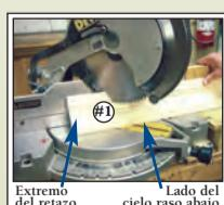
**Cómo cortar la pieza No. 1:** Coloque la moldura de cornisa (No. 1) en posición invertida (el lado del cielo raso hacia abajo) en la caja de ingletes y sujetela firmemente la moldura de cornisa contra la caja de ingletes. Dispóngala a un ángulo de 45 grados hacia la derecha y realice el corte.
