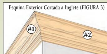
Cómo medir y cortar una esquina exterior usando un corte a inglete compuesto en lugar de un bloque de esquina. Utilice las mismas técnicas empleadas para cortar las esquinas interiores, excepto que la distancia A es ahora la medida más corta y la distancia B es ahora el borde más largo topado contra el cielo raso.
